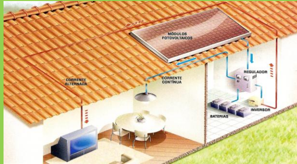
Sistema de energia solar fotovoltaica Fonte: Baima, 2005.
