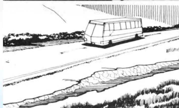
Erosão em plataforma – Fonte IPT
