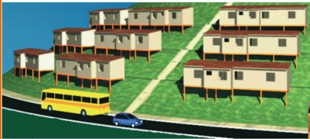
Figura 10: Proposta de sistema construtivo híbrido (estrutura de embasamento de aço e construção convencional sobreposta) que dispensa maiores movimentos de terra na ocupação de encostas
